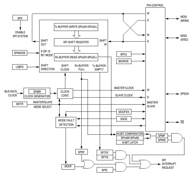
Figure 15-4. SPI Module Block Diagram
